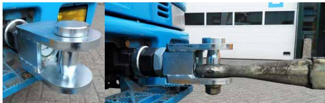
5. slepen met een trekstang / towing with a tow bar / abschleppen mit einer Zugstange / remorquage avec une barre de traction
