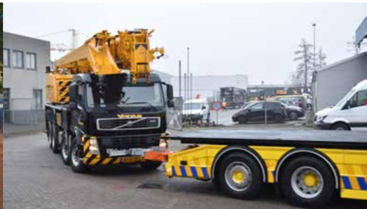
2. laten volgen achter de bergingsauto / following behind the recovery truck / hinter dem Bergungsfahrzeug folgen lassen / remorquage derrière la dépanneuse
