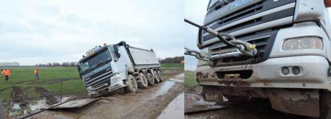
1. lieren met kabels/ winching with cables/ Winden mit Kabeln/ treuillage avec des câbles
